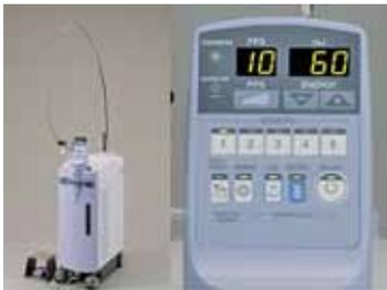
図2 Er:YAGレーザー装置。術者は、出力(mJ)、Hz(pulse/sec)、エアと注水をパネルで設定する。
