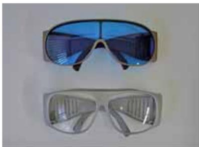
図4 Er:YAGレーザーや炭酸ガスレーザーは、透明な防護眼鏡だが、可視光線や可視光線に近いレーザーの一部は色が着いている。
